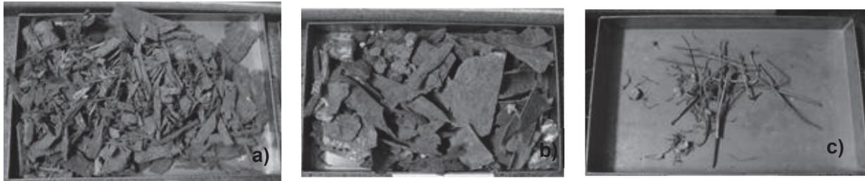
**Figura 2.4.** Triagem de materiais contaminantes: a) madeira, b) plásticos, c) ferro
