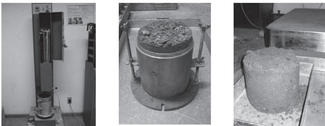
**Figura 2.9.** Compactador mecânico e corpo de prova de RCD após compactação Proctor
