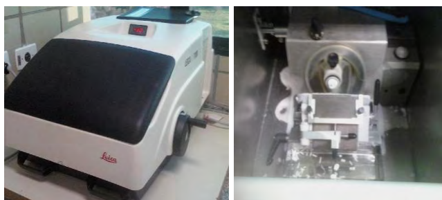
Figura 6 - Criostato(CM 1100 - LEICA), vista externa e interna respectivamente
