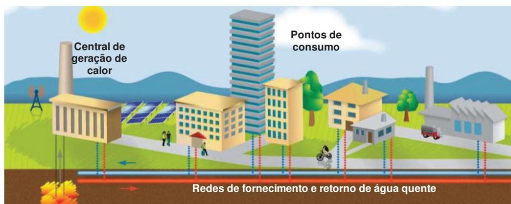
Figura 12: Esquema de sistema de aquecimento distrital. Fonte: DHC Technology Platform (2009)
