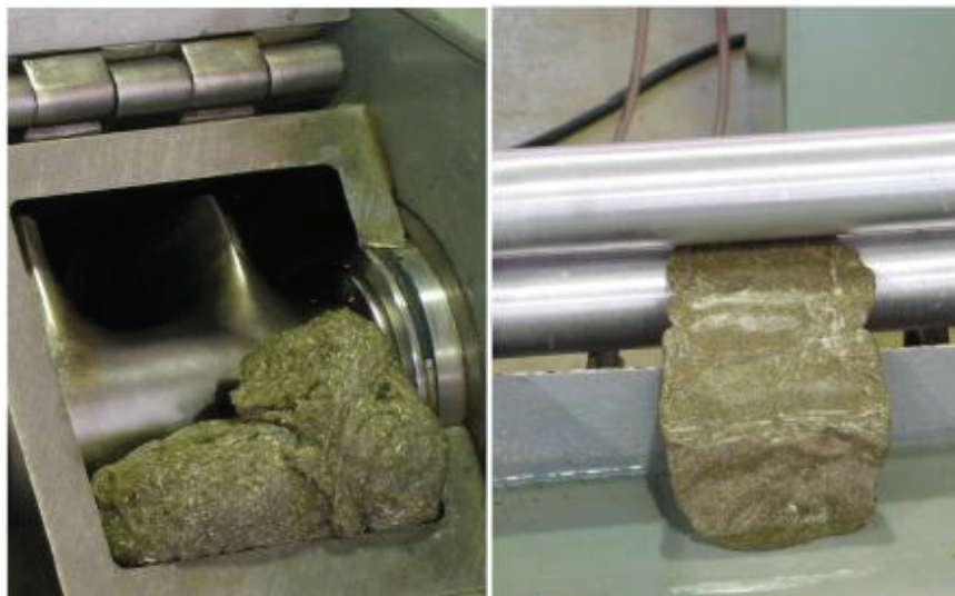
Figura 19. Esquema de preparação dos compósitos BNT utilizando o misturador termocinético.
