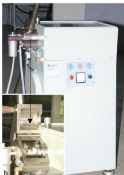
Figura 18. Homogeneizador de plásticos de laboratório (misturador termocinético) e no detalhe, cápsula do compartimento mistura.
