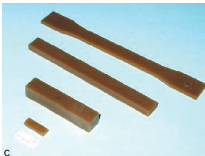
Figura 21. corpos de prova provenientes do molde instalado na injetora: 1 - tração, 2 - impacto, 3 - flexão e 4 - cisalhamento.
