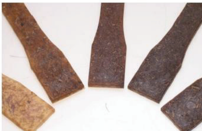
Figura 22. Compósitos de polipropileno reforçados com bagaço (5, 10, 15, 20 e 25% (m/m) de fibras —esquerda para a direita) obtidos através da extrusora;
